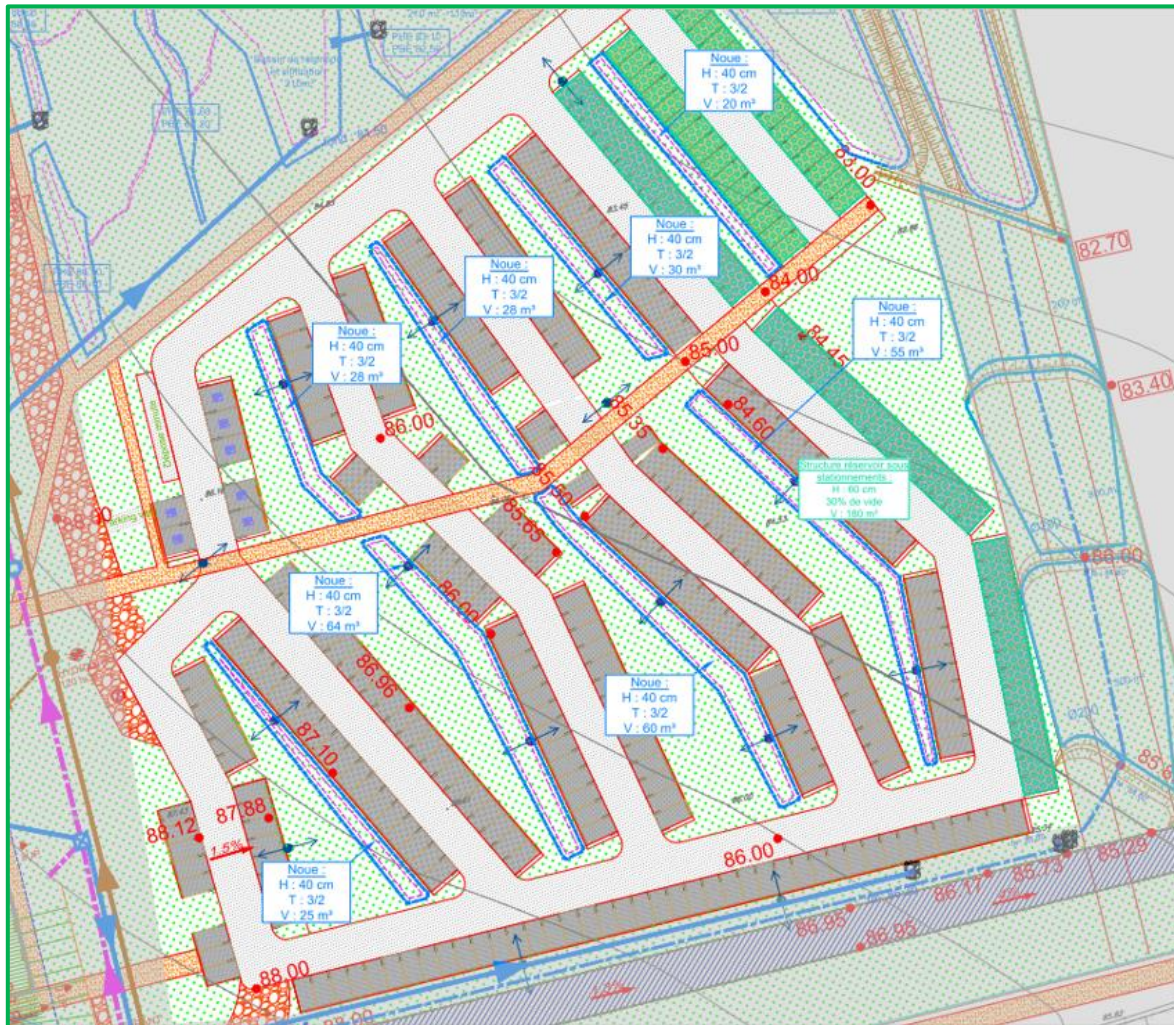
Figure 26 : Gros plan sur la gestion des eaux pluviales du parking (INFRA Services)
