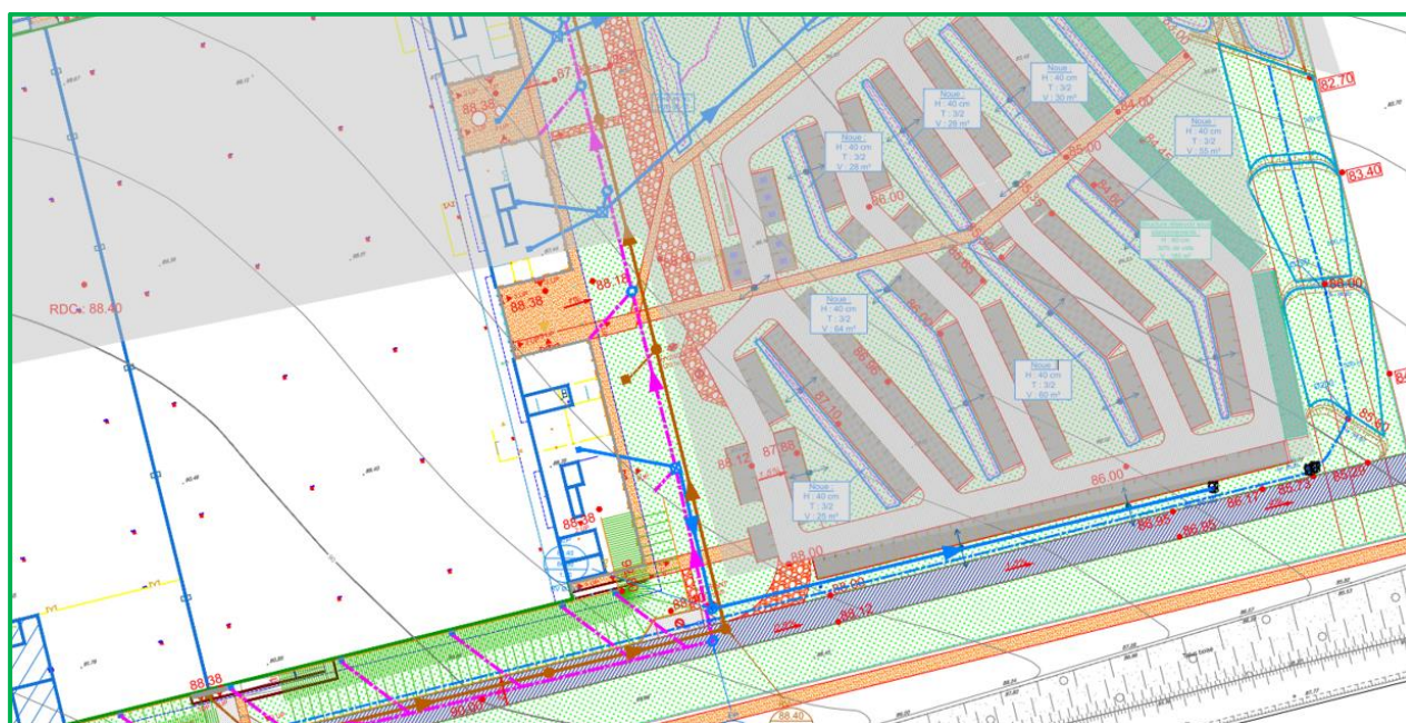
Figure 29 : Gros Plan sur la gestion des eaux pluviales des toitures (3) (INFRA Services)
